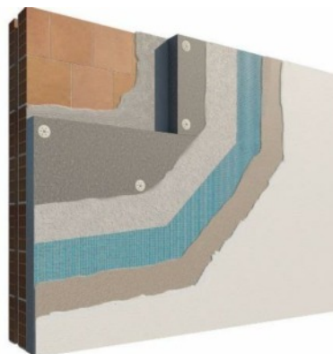
B2 -f _ Isolamento in EPS
